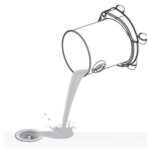
Fig. 12 – Removiendo el líquido del reservorio
